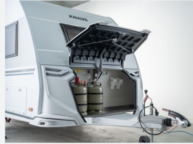
Gaskasten mit Außenklappe
