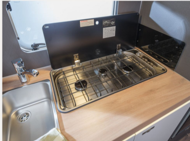
3-Flammen-Kocher mit Glasabdeckung, Spülbecken aus Edelstahl, versenkt
