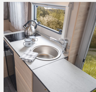
Aufklappbare Arbeitsplattenverlängerung an der Küche
