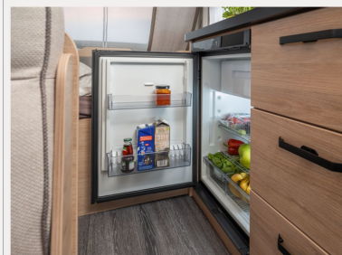
Hinweise: Gasbetrieb während der Fahrt nur in Verbindung mit Mono- bzw. Duo Control zulässig
