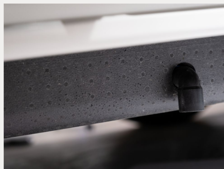
Isolierhaube Abwassertank, beheizbar
