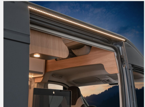
Regenrinne über der Schiebetür mit LED (dimmbar)
