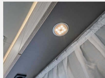
LED-Einbauspotlights über Sitzgruppe, LED-Ambientebeleuchtung (dimmbar) über Deckenschrankklappen
