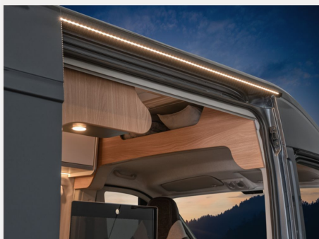
Regenrinne über der Schiebetür mit LED (dimmbar)
