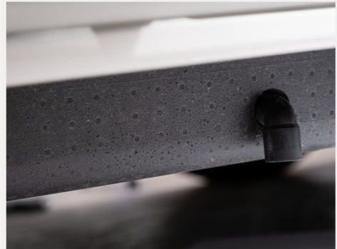
Isolierhaube Abwassertank, beheizbar
