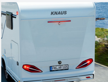
FoldXpand Heckkonzept: Vollplastische Heckwand mit bündig integriertem Heckleuchtenträger
