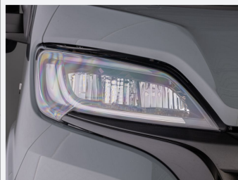
Voll-LED-Frontbeleuchtung (Abblend-, Fern- und Blinklicht)
