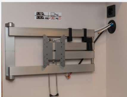
TV-Vorbereitung mit Steckdose und Kabelverlegung/-durchführung
