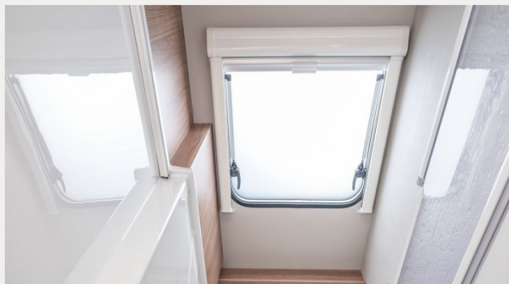
Ausstellfenster 52 x 50 cm, mit Insektenschutz und Verdunklung (Toilettenraum)
