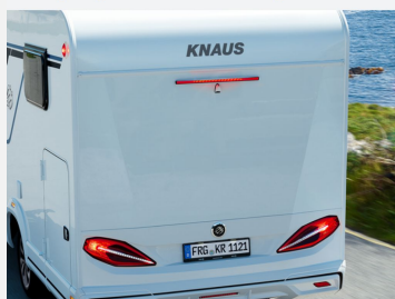
FoldXpand Heckkonzept: Vollplastische Heckwand mit bündig integriertem Heckleuchenträger
